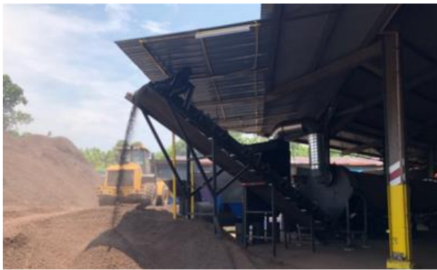
Straits Green Energy 乾燥機つき篩機による高品位PKS
